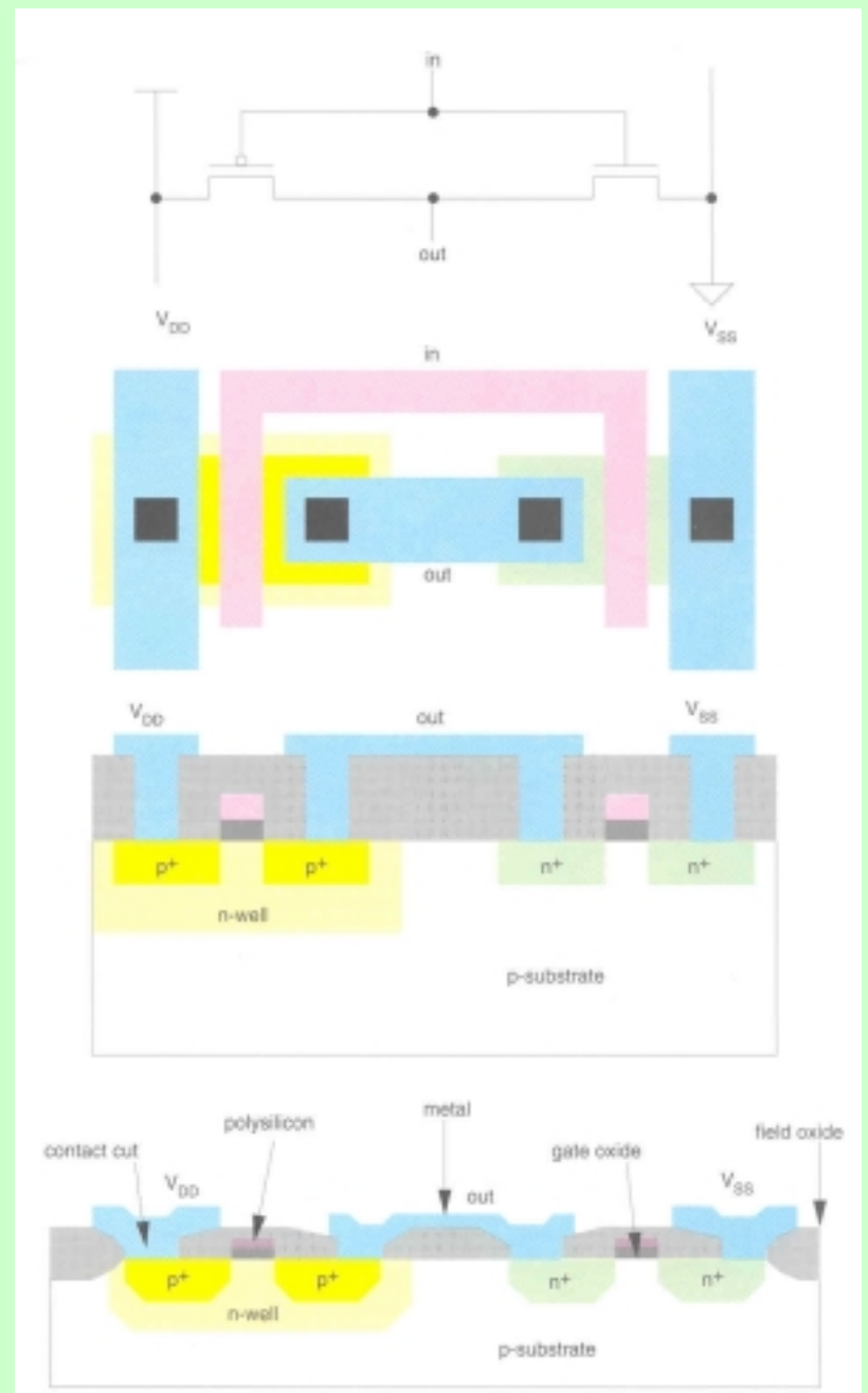
Przekrój inwertera CMOS, proces n-well
